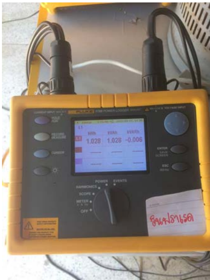
ภาพที่ ค-3 เครื่องบันทึกพลังงานไฟฟ้า
