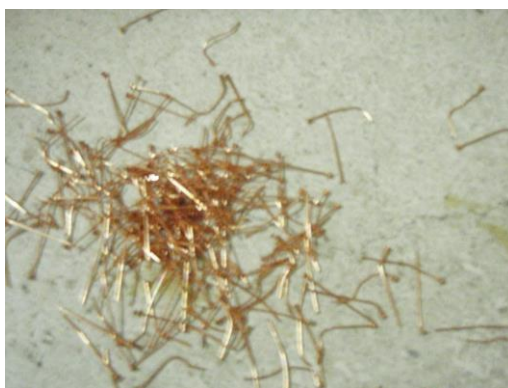
ภาพที่ 3.12 ขาทองแดงส่วนหนึ่งที่ชำรุดจากกระบวนการของเครื่องจักรกลเรียงขาทองแดง
