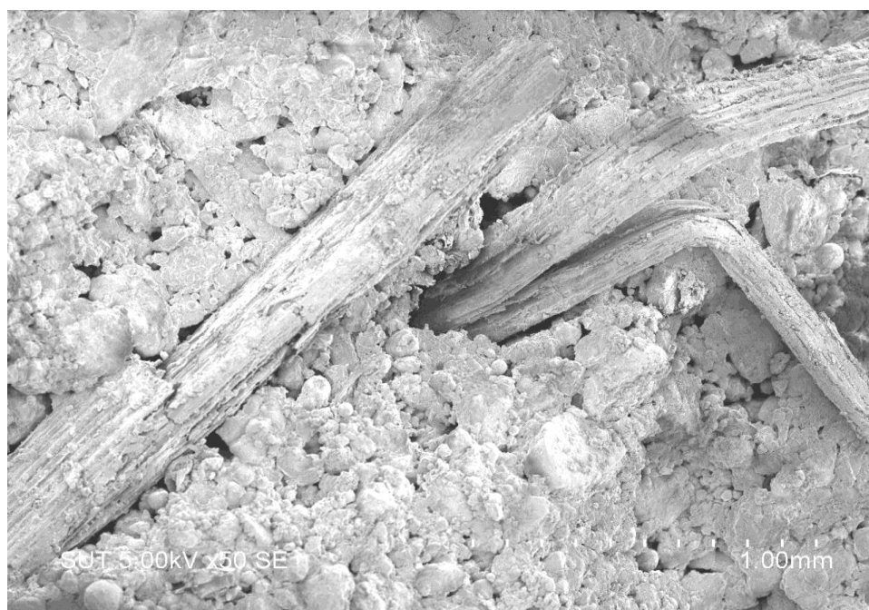
ภาพที่ 4.8 ภาพถ่ายขยายกำลังสูงขนาด 50 เท่าของอิฐบล็อกประสานเมื่อแทนที่ดินแดงด้วยชานอ้อย
