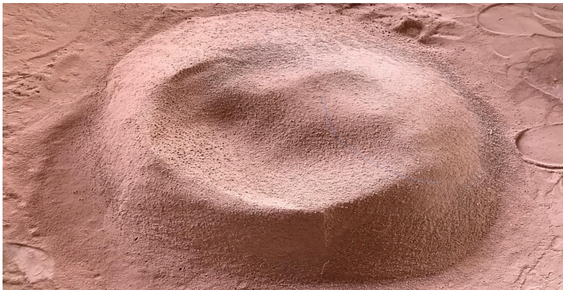
ภาพที่ 3.2 ดินแดงที่ผ่านการร่อนผ่านตะแกรง เบอร์ 4 แล้ว
