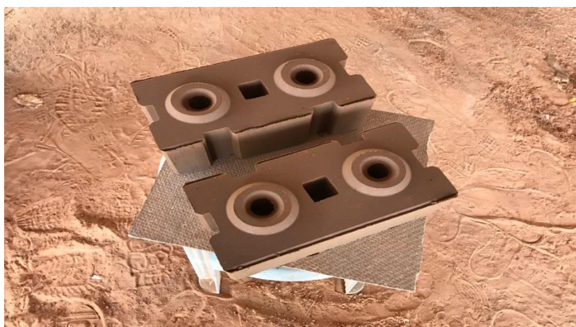
ภาพที่ 3.4 อิฐบล็อกประสานที่ผ่านการขึ้นรูปแล้ว
