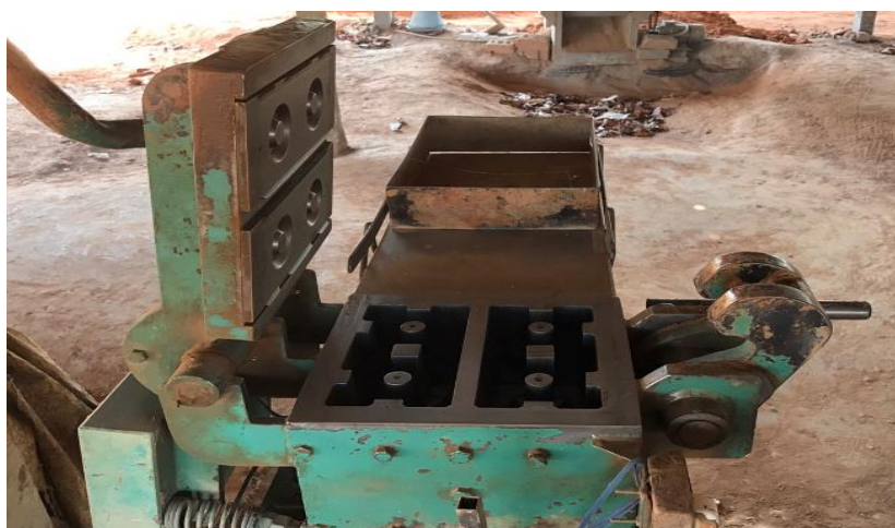
ภาพที่ 2.4 เครื่องอัดบล็อกประสานโดยใช้แรงคน
