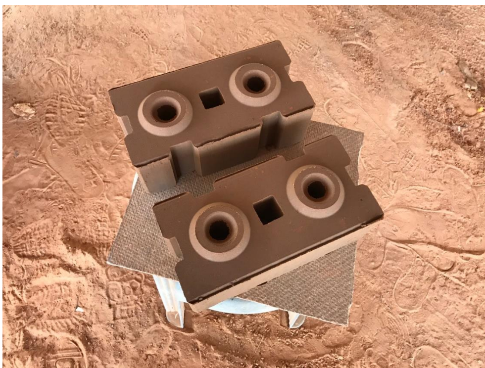
ภาพที่ 2.2 อิฐบล็อกประสานตรงหรือทรงสี่เหลี่ยม
