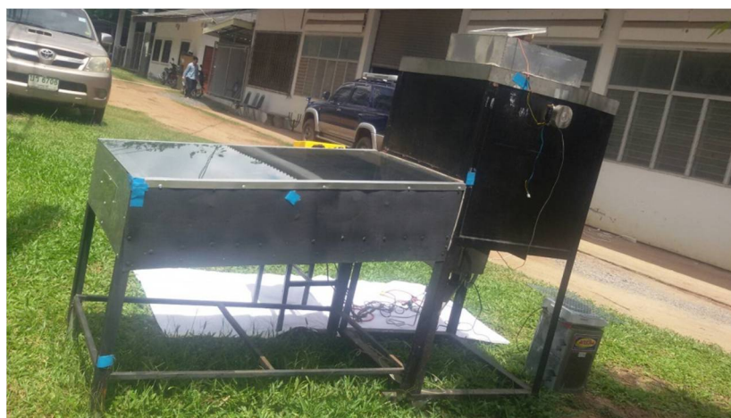
ภาพที่ 4.1 ด้านข้างเครื่องอบแห้งพลังงานแสงอาทิตย์ร่วมกับรังสีอินฟราเรด
