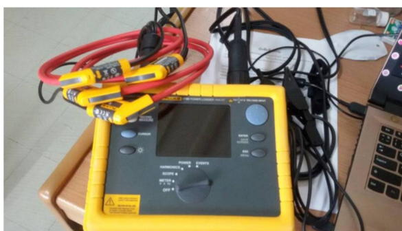
ภาพที่ 3.5 เครื่องวัดค่าพลังงาน Power factor
