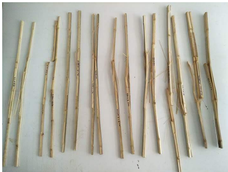
ภาพประกอบที่ 19 ภาพการวิบัติของไม้ไผ่หลังการทดสอบ
