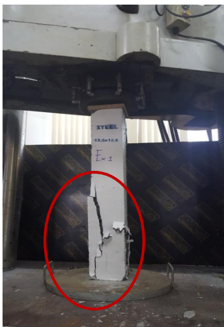
ภาพประกอบที่ 25 รูปแบบการวิบัติของเสาคอนกรีต ขนาด 12.5x12.5 เซนติเมตร
