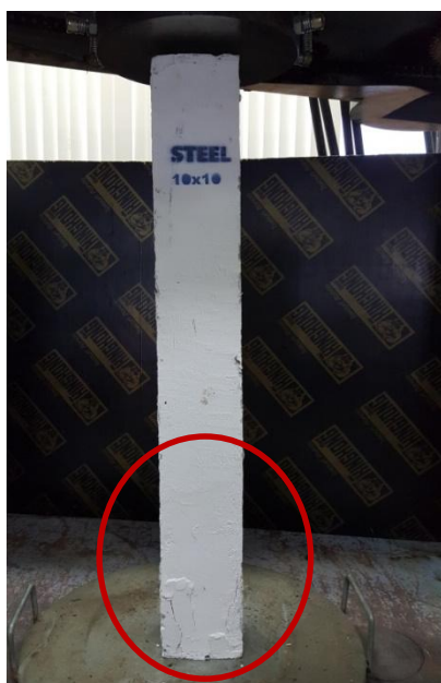
ภาพประกอบที่ 24 รูปแบบการวิบัติของเสาคอนกรีต ขนาด 10x10 เซนติเมตร
