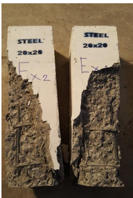
ภาพประกอบที่ 28 การหลุดร่อนของเนื้อคอนกรีตหลังการวิบัติ
