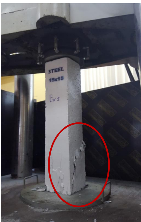
ภาพประกอบที่ 26 รูปแบบการวิบัติของเสาคอนกรีต ขนาด 15x15 เซนติเมตร
