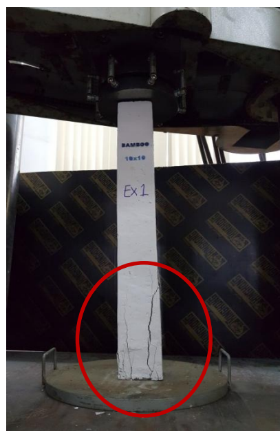
ภาพประกอบที่ 24 รูปแบบการวิบัติของเสาคอนกรีต ขนาด 10x10 เซนติเมตร
