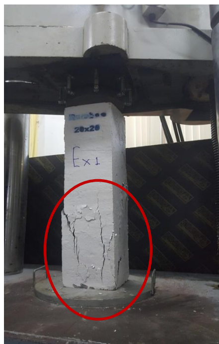
ภาพประกอบที่ 27 รูปแบบการวิบัติของเสาคอนกรีต ขนาด 20x20 เซนติเมตร
