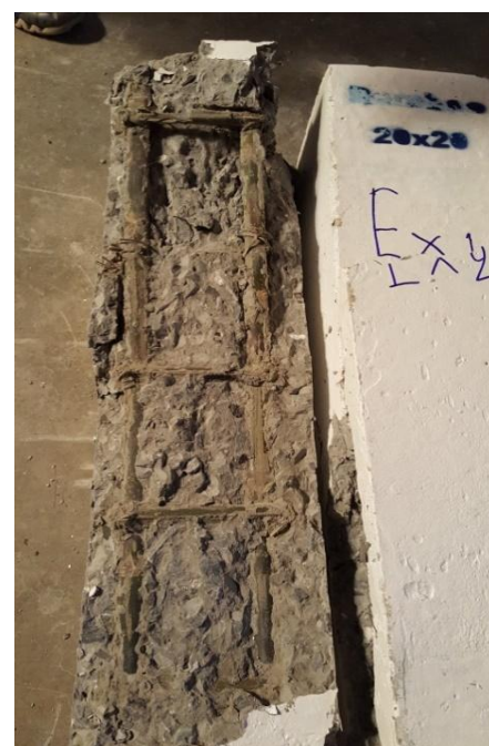
ภาพประกอบที่ 28 การหลุดร่อนของเนื้อคอนกรีตหลังการวิบัติ
