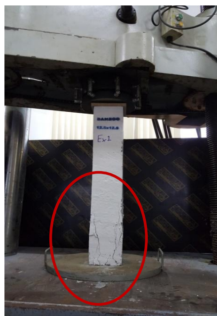
ภาพประกอบที่ 25 รูปแบบการวิบัติของเสาคอนกรีต ขนาด 12.5x12.5 เซนติเมตร
