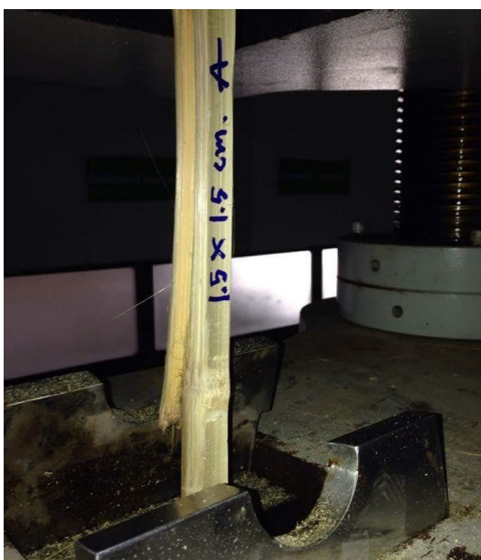
ภาพประกอบที่ 14 การทดสอบแรงดึงของไม้ไผ่
