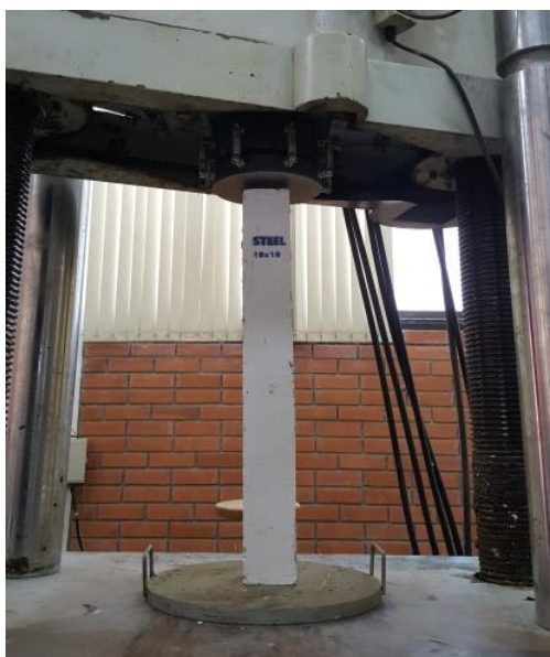
ภาพประกอบที่ 15 การทดสอบเสาคอนกรีต
