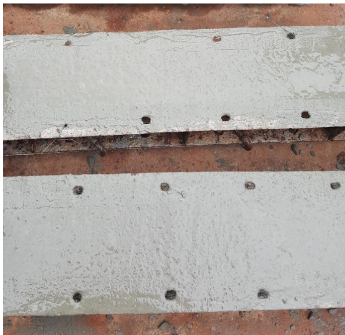
ภาพประกอบที่ 37 การหล่อตัวอย่างเสาคอนกรีต
