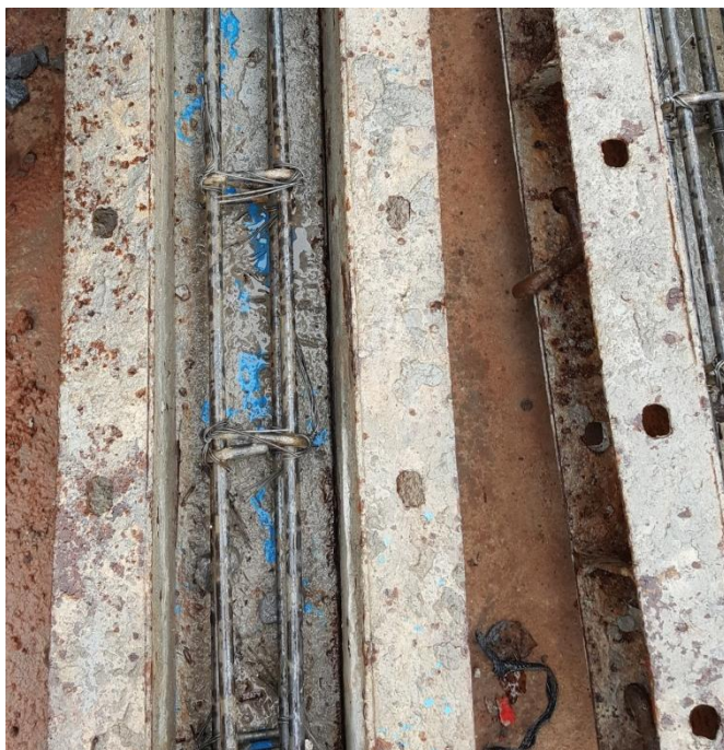
ภาพประกอบที่ 34 การหล่อตัวอย่างเสาคอนกรีต
