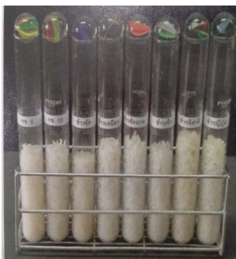
ภาพประกอบ 2.3 การหุงข้าวในหลอดแก้วเพื่อตรวจสอบการยีดตัวของเมล็ดข้าว การขยายปริมาตร และการอุ้มน้ำของข้าวสุก ที่มา : อรอนงค์ (2556)
