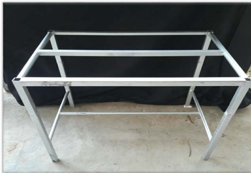
ภาพประกอบ 3.4 โครงสร้างฐานของเครื่องห้องอบแห้ง
