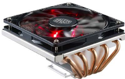
ภาพที่ 3.9 ชุดระบายความร้อนซีพียูแบบท่อความร้อน
