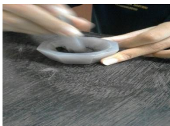
รูปที่ 3.6 บดผงตัวอย่างให้เข้ากันกับโพลีไวนิลแอลกอฮอล์
