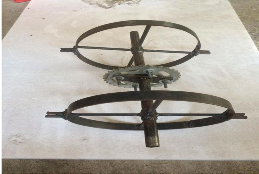
รูปที่ 3.3 ลักษณะด้านข้างวงล้ออุปกรณ์ปักดำต้นกล้า
