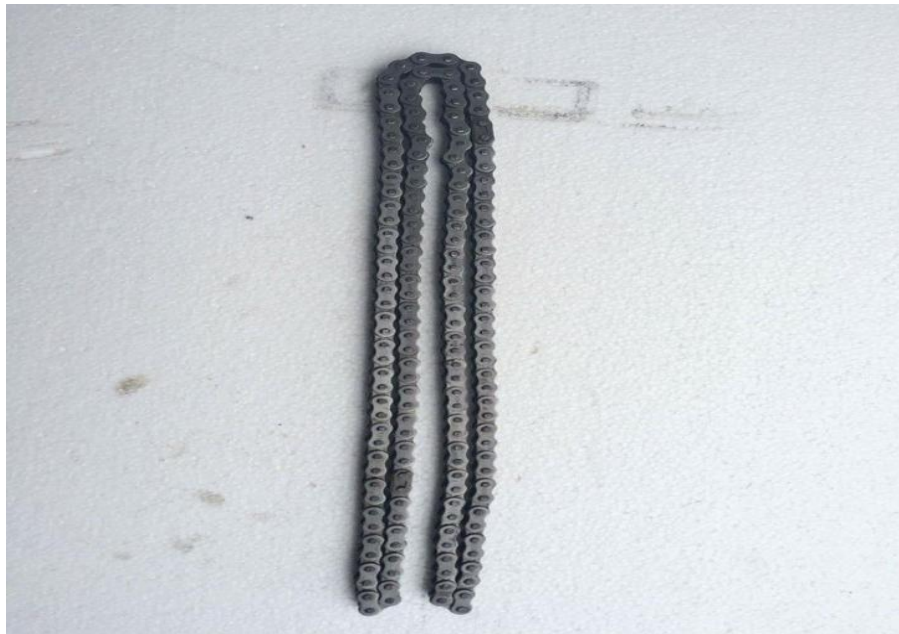
รูปที่ 3.4 ลักษณะโซ่ที่ทำหน้าที่ดึงแกนเพลลา
