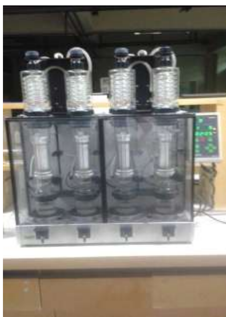
ภาพที่ 6.18 การสกัดโดยใช้ตัวทำละลายเป็น เอทานอล:เบนซีน ในอัตราส่วน 64:137 ระยะเวลา 6 ชั่วโมง
