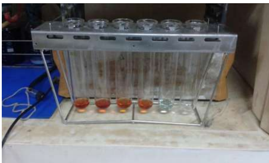
ภาพที่ 6.34 การชั่งตัวอย่างรูปถาชี 0.5 \pm 0.1 กรัม เติมสารเร่งปฏิกิริยา 5 กรัม + กรดซัลฟิวริก 15 มิลลิลิตร + สารละลายไฮโดรเจนเปอร์ออกไซด์ 36% (v/v) 1 มิลลิลิตรใส่หลอดย่อย
