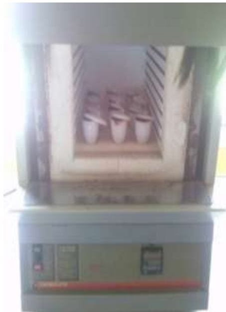
ภาพที่ 6.54 การเผาตัวอย่างรูปถาษีที่เตาเผา 550 องศาเซลเซียสนาน 2 ชั่วโมง
