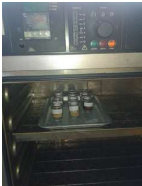
ภาพที่ 6.52 การอบตัวอย่างรูปถั่วเขียวหลังการสกัดเยื่อใยหยาบที่ 105 องศาเซลเซียส 16-18 ชั่วโมง
