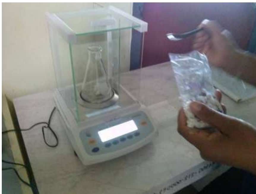
ภาพที่ 6.25 การชั่งตัวอย่างรูปถาพี 0.7 \pm 0.1 กรัม ใส่ในขวดรูปชมพู่ขวด 250 มิลลิลิตร
