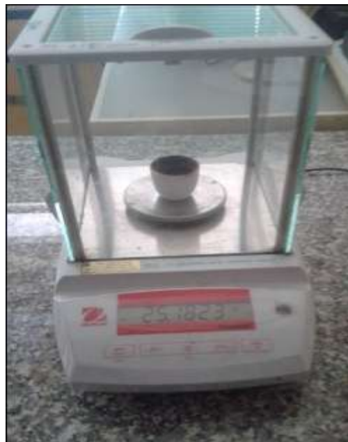
ภาพที่ 6.14 การนำตัวอย่างรูปภาซีที่ได้ชั่งน้ำหนักหลังเผา
