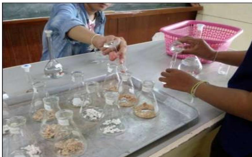
ภาพที่ 6.26 การเติมแอสติคเข้มข้น 0.6% (v/v) 10 มิลลิลิตร และสารละลายโซเดียมไฮดรอกไซด์ เข้มข้น 0.02% (w/v) 10 มิลลิลิตร สารละลายโซเดียมคลอไรด์ 20% (w/v) 1 มิลลิลิตร
