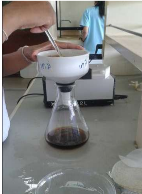
ภาพที่ 6.5 ล้างตัวอย่างรูปถาษีด้วยเอทานอล 95% (v/v) โดยใช้เครื่อง Suction จนสะอาด pH = 7
