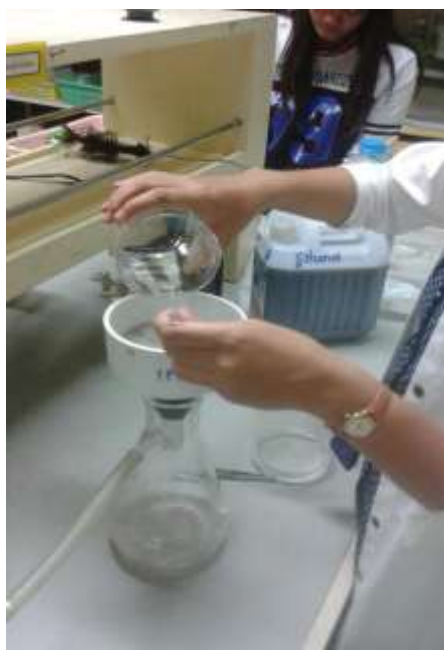
ภาพที่ 6.22 การล้างสารที่ได้ด้วยน้ำกลั่นปริมาตร 500 มิลลิลิตร ผ่านเครื่องกรองระบบสุญญากาศ
