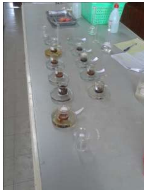
ภาพที่ 6.30 การเติมโซเดียมไฮดรอกไซด์เข้มข้น 17.5% (w/v) หรือ 5.21 นอร์มอล 3 มิลลิลิตร ที่ทิ้งไว้ 35 นาที
