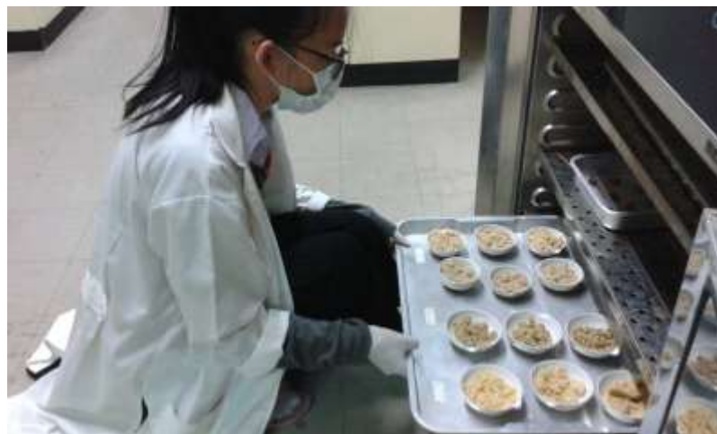
ภาพที่ 6.8 การนำตัวอย่างรูปภาชีเข้าตู้อบ ที่อุณหภูมิ 60 องศาเซลเซียส 24 ชั่วโมง
