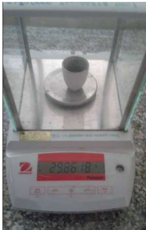
ภาพที่ 6.10 การชั่งตัวอย่างรูปถาษี อย่างละ 1 กรัม ตัวอย่างละ 3 ช้า ใส่ในคูลชิเบิลเผา
