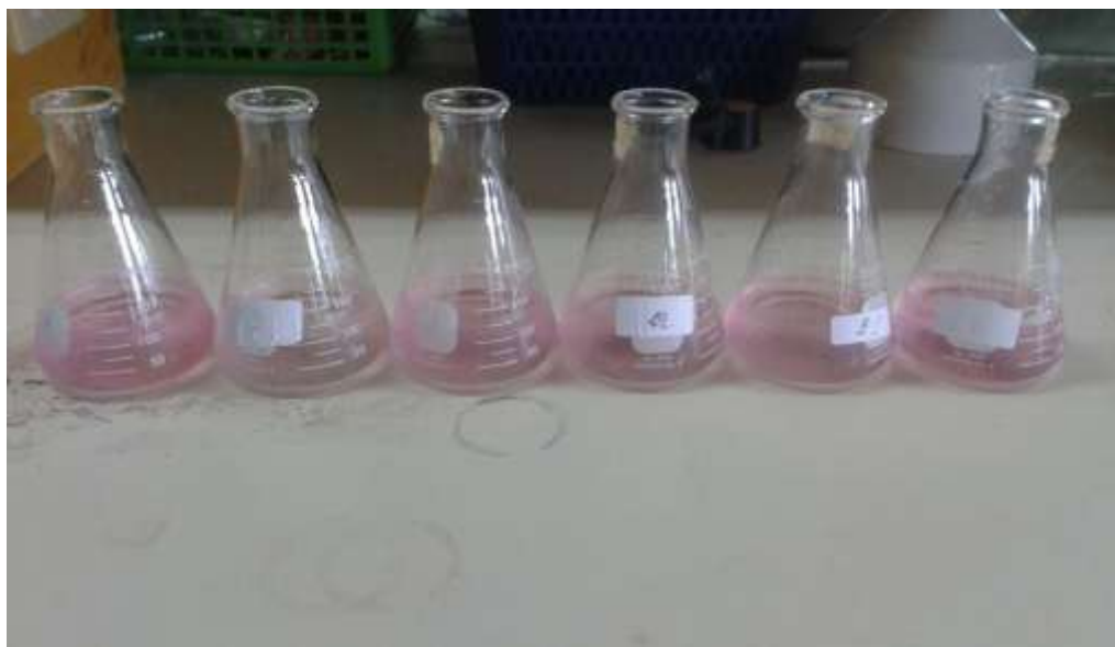
ภาพที่ 6.43 สารละลายที่ได้หลังการไทเทรตจะเปลี่ยนจากสีเขียวเป็นสีชมพู
