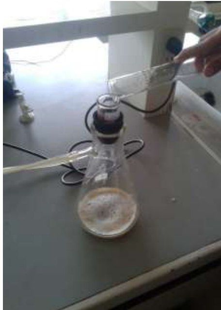
ภาพที่ 6.23 การกรองผ่านเครื่องกรองระบบสุญญากาศ และล้างสารที่ได้ด้วย น้ำร้อน 500 มิลลิลิตร
