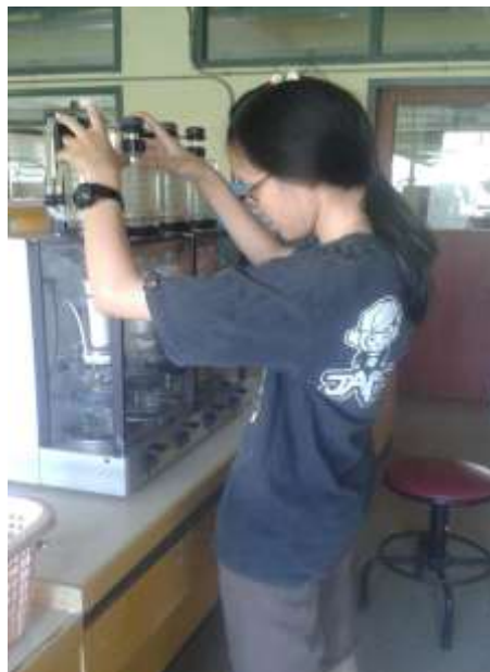
ภาพที่ 6.46 การนำ thimble ที่มีตัวอย่างรูปถาพีประกอบในเครื่อง B-811
