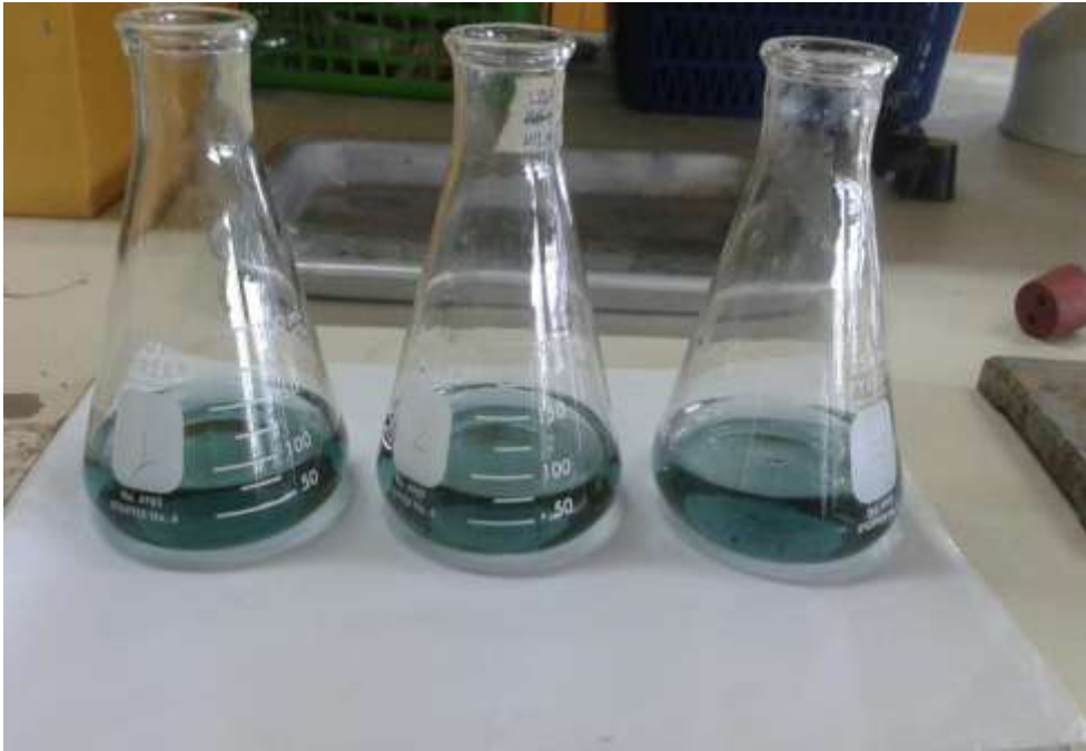
ภาพที่ 6.41 สารละลายที่ได้จากการกลั่นจะเปลี่ยนจากสีชมพูเป็นสีเขียว
