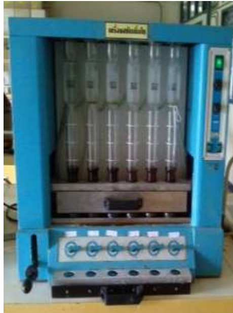
ภาพที่ 6.51 การนำตัวอย่างรูปถั่วเขียวเข้าเครื่องสกัดเยื่อใย
