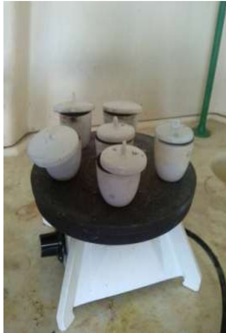
ภาพที่ 6.11 การเผาตัวอย่างรูปภาชีด้วย hot plate จนหมดควัน
