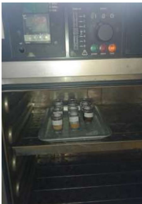
ภาพที่ 6.17 การอบตัวอย่างรูปภาชนะที่ 60 องศาเซลเซียส นาน 1 ชั่วโมง
