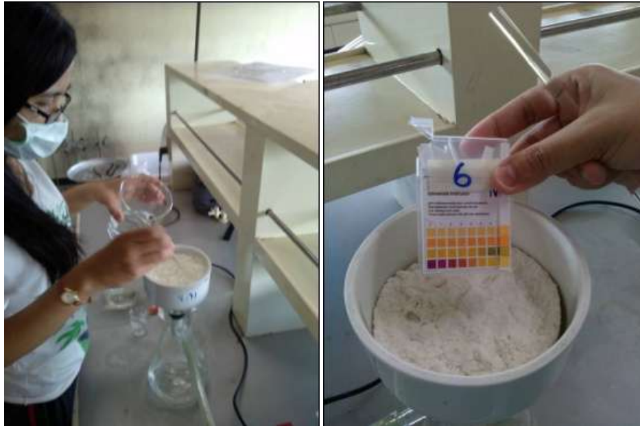
ภาพที่ 6.7 การล้าง สารละลายโซเดียมไฮโปคลอไรต์ + สารละลายกรดแอสติค จนสะอาด pH = 7
