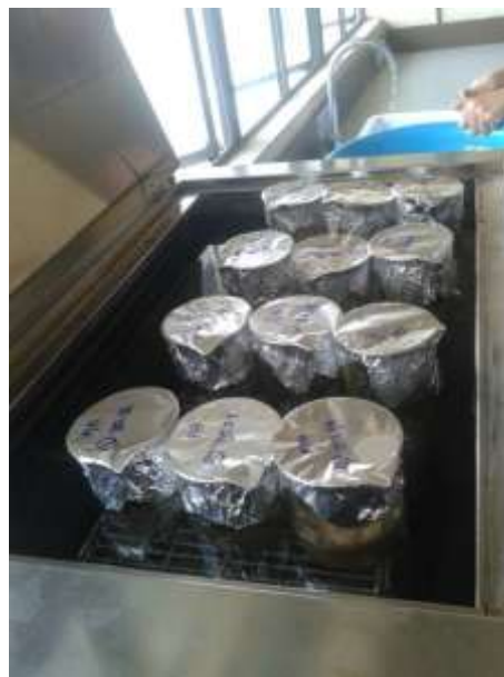
ภาพที่ 6.32 การต้มตัวอย่างรูปถ้วยให้เดือดนาน 4 ชั่วโมง ตั้งทิ้งไว้ 24 ชั่วโมง
