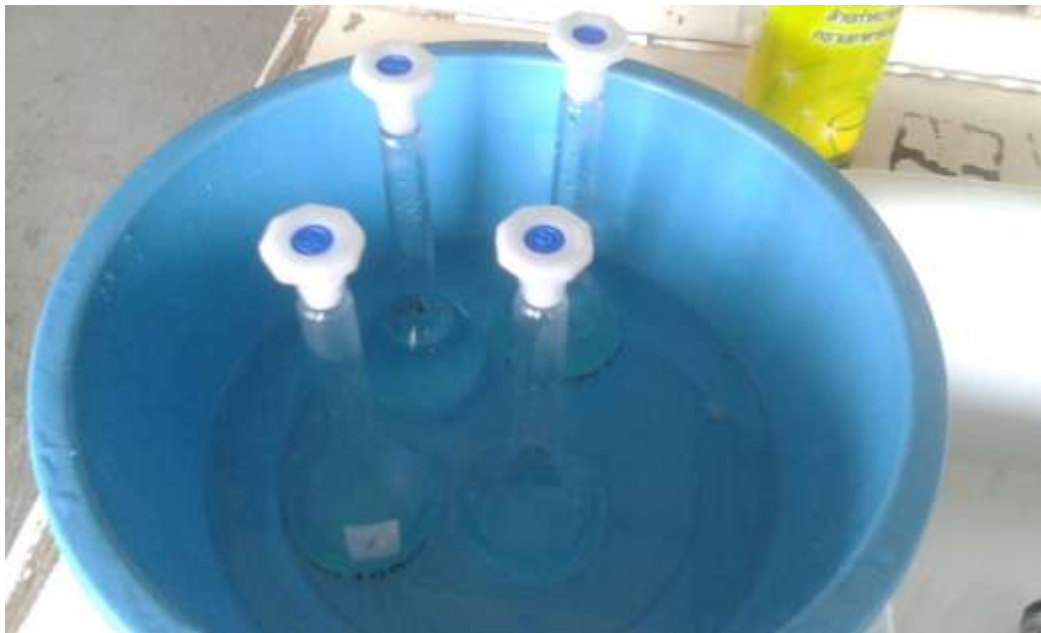
ภาพที่ 6.38 การแช่ตัวอย่างรูปภาชนะในอ่างน้ำจนสารละลายเย็น
