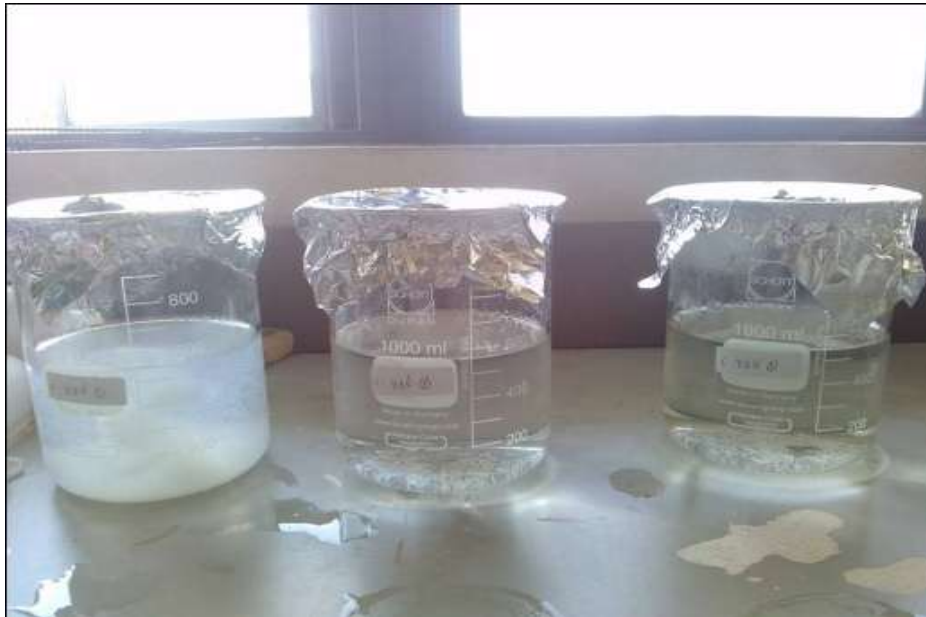
ภาพที่ 6.31 การทดสอบละลายใส่ปิกรเกอร์ 1,000 มิลลิลิตร เติมน้ำกลั่น 560 มิลลิลิตร
