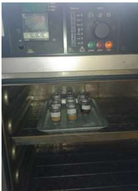
ภาพที่ 6.21 การนำตัวอย่างรูปภาซีเข้าอบที่อุณหภูมิ 105 องศาเซลเซียส นาน 1 ชั่วโมง
