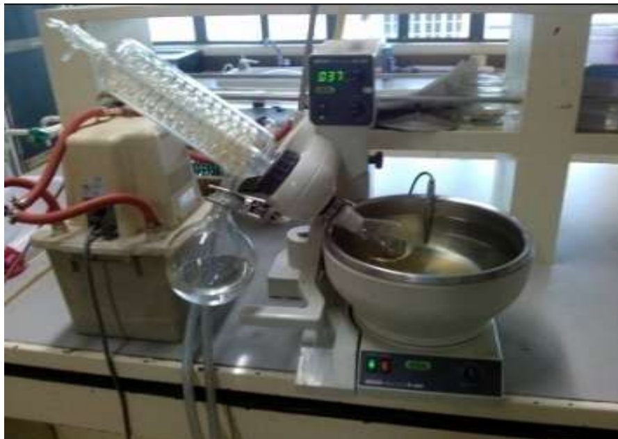
ภาพที่ 6.20 การนำสารละลายแต่ละชนิดไปกลั่นระเหยเอาตัวทำละลายออกด้วยเครื่องกลั่นระเหยสารแบบหมุน (Rotary evaporator)
