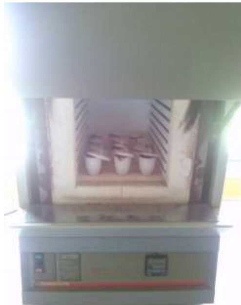
ภาพที่ 6.12 การนำตัวอย่างรูปภาชีเข้าเตาเผา ที่อุณหภูมิ 600 องศาเซลเซียส 2 ชั่วโมง
