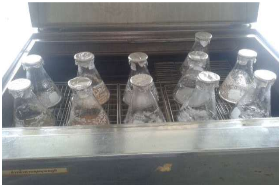
ภาพที่ 6.27 การนำตัวอย่างรูปภาชีอ่อนใน water bath อุณหภูมิ 70 องศาเซลเซียส ทุกๆ 1 ชั่วโมง ให้เติมสารละลายโซเดียมไฮโปคลอไรด์อีก 1 มิลลิลิตร รวม 4 ชั่วโมง
