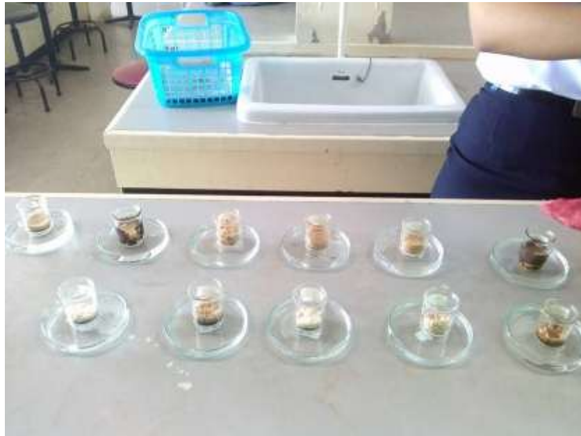
ภาพที่ 6.29 การวาง sinter glass crucible ลงใน dish ที่มีน้ำสูง 1 เซนติเมตร เดิมโซเดียมไฮดรอกไซด์เข้มข้น 17.5% (w/v) หรือ 5.21 นอร์มอล 3 มิลลิลิตร คนด้วยแท่งแก้ว นาน 5 นาที
