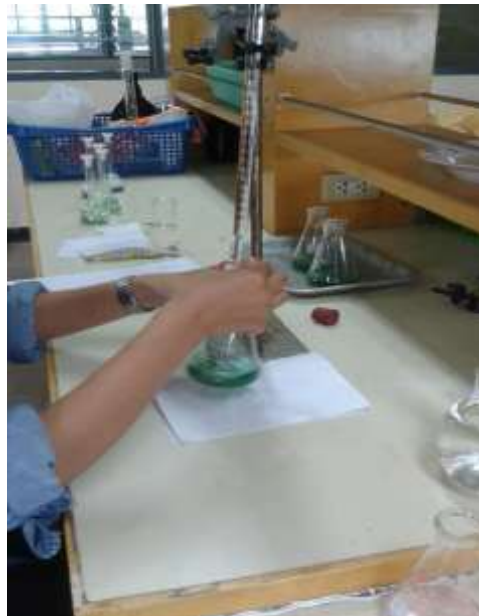
ภาพที่ 6.42 การไทเทรตหาไนโตรเจนด้วยสารละลายมาตรฐานกรดซัลฟิวริก
