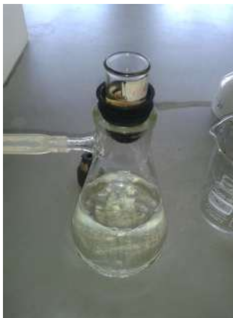
ภาพที่ 6.19 การล้างตัวอย่างรูปถ่ายด้วย เอทานอล 100 มิลลิลิตร ผ่านเครื่องกรองระบบสุญญากาศ
