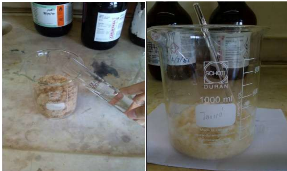
ภาพที่ 6.6 สารละลายโซเดียมไฮโปคลอไรด์ + สารละลายกรดแอสติก ในอัตราส่วน 1:1 ตั้งทิ้งไว้ คน และสังเกตสีของตัวอย่างรูปถาษี ถ้าเปลี่ยนเป็นสีขาวนำไปล้างทันที
