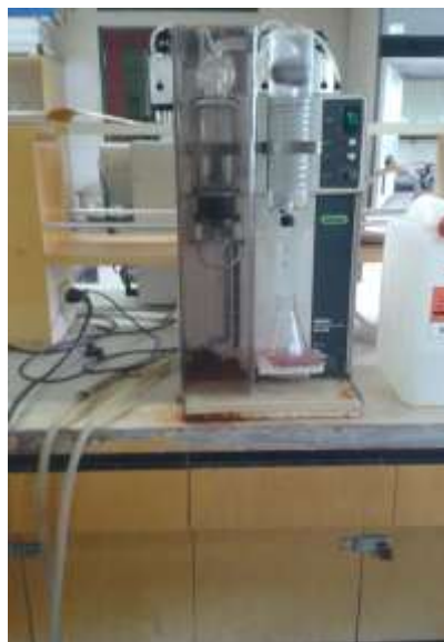
ภาพที่ 6.40 การใส่หลอดตัวอย่างรูปภาซีที่ผ่านการย่อยเข้ากับเครื่องกลั่น + กรดบอริกความเข้มข้น 4% (v/v) ปริมาณ 25-30 มิลลิลิตร (หลอดแรกเป็นน้ำกลั่น และเรียงไปเรื่อยๆจนครบ 6 หลอด)
