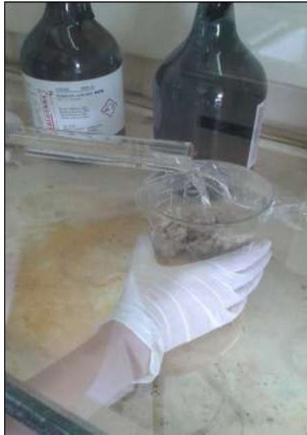
ภาพที่ 6.3 การแบ่งตัวอย่างรูปถ่ายซีมา และเติมเอทานอล 95% (v/v) นำไปอุ่นใน Water bath 24 ชั่วโมง
