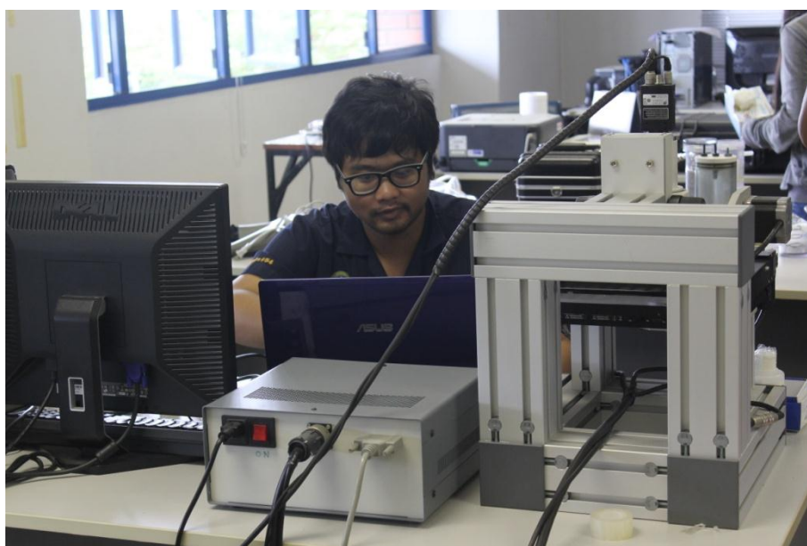
รูปที่ จ-8 รูปแสดงการบันทึกค่าจากเครื่อง Atmos 12 DPX ที่สถาบันเทคโนโลยีนิวเคลียร์แห่งชาติ
