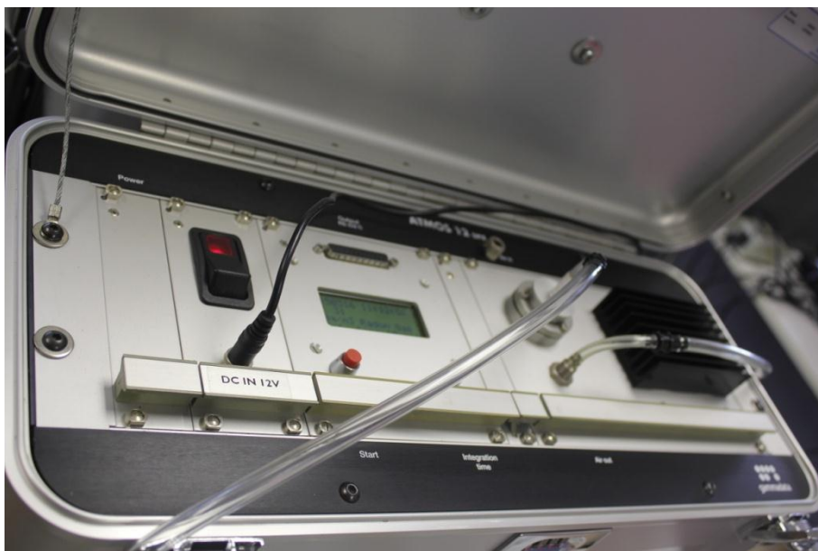
รูปที่ จ-9 รูปแสดงหน้าปัดและการต่อสายของเครื่อง Atmos 12 DPX ที่สถาบันเทคโนโลยี นิวเคลียร์แห่งชาติ
