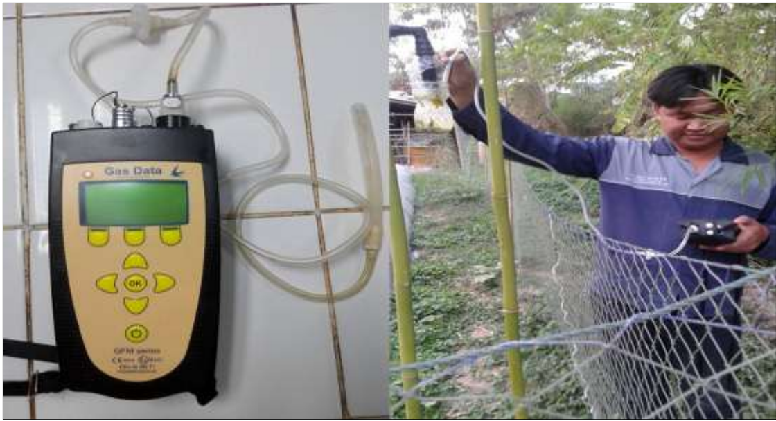
ภาพที่ ก-17 ลักษณะการวัดเพื่อตรวจหาปริมาณ \text{CH}_4 , \text{CO}_2 , \text{O}_2 , \text{H}_2\text{S} และก๊าซอื่นๆ
