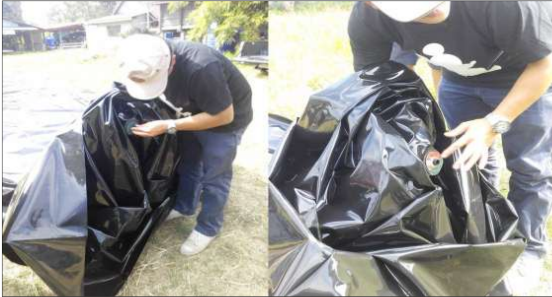
ภาพที่ ก-3 เกลียนอก-ใน PVC (Polyvinyl Chloride) ต่อกับถุงหมัก LDPE (Low Density Polyethylene)
