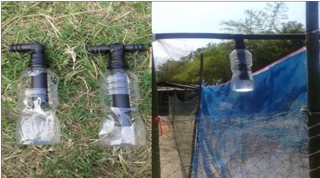
ภาพที่ ก-14 ติดตั้งวาล์วขูดน้ำเพื่อลดแรงดันเมื่อแรงดันจากบ่อหมักเกิน
