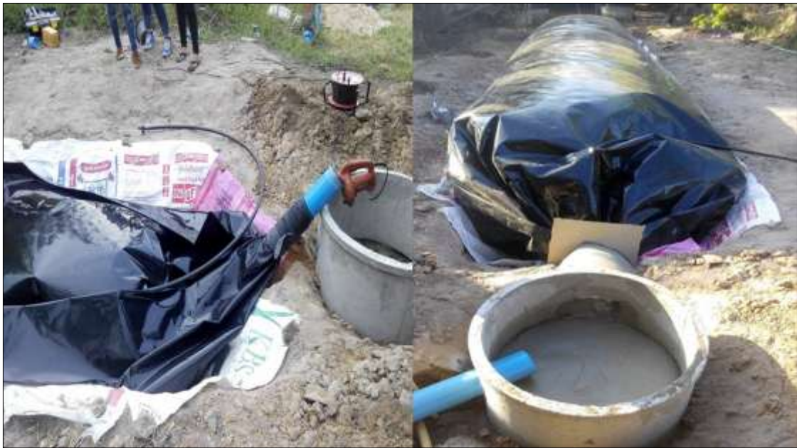
ภาพที่ ก-5 เป่าลมเพื่อทดสอบรอยรั่วของถุงหมัก LDPE (Low Density Polyethylene)
