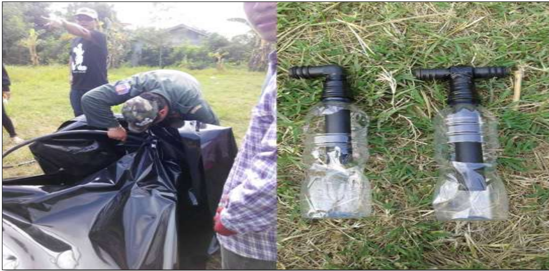
ภาพที่ 3.7 ประกอบสายส่งก๊าซและขวดปรับแรงดัน
