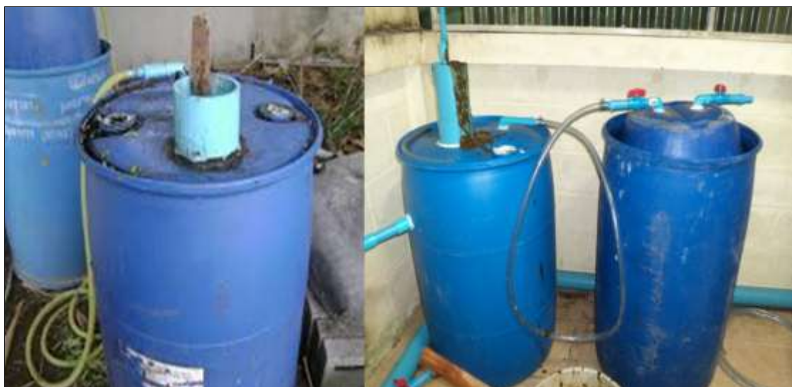
ภาพที่ 2.6 ถังหมักแบบถังพลาสติก PVC 200 ลิตร ที่มา : เค.พี.แอล.เวิร์ลด์เทรดดิ้ง (2558)
