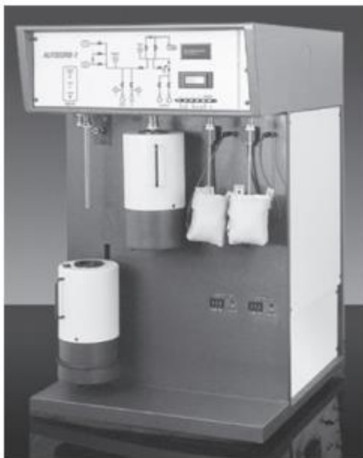
ภาพที่ ข.4 เครื่องวิเคราะห์ขนาดพื้นที่ผิวจำเพาะและปริมาตรรูพรุน
