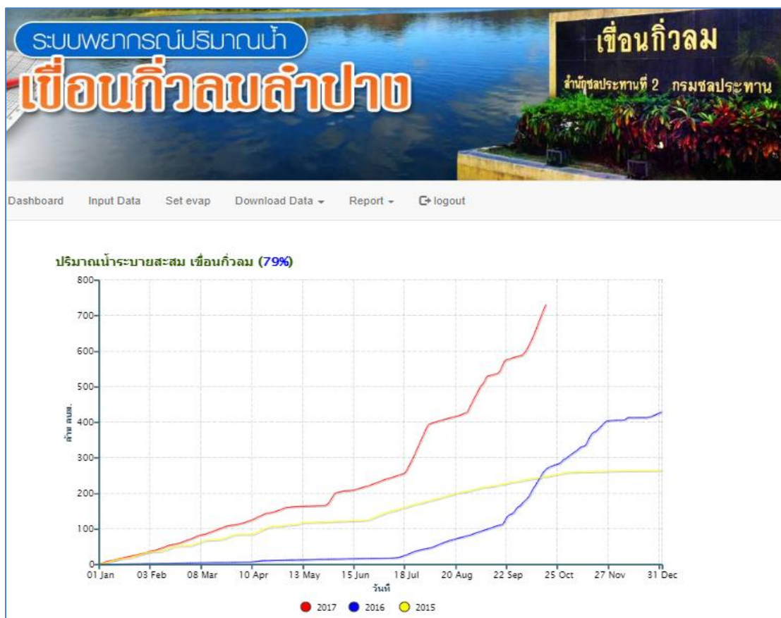
ภาพที่ ง.17 รายงานปริมาณการปล่อยน้ำออกจากเขื่อนสะสม
