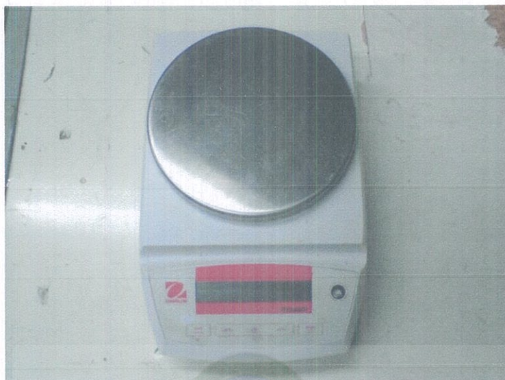
รูปที่ ง-7 เครื่องชั่งดิจิทัล 2 ตำแหน่ง ยี่ห้อ (OHAUS) รุ่น PA4102
