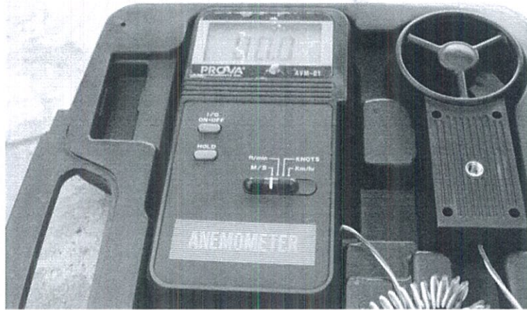
ภาพที่ ซ-1 เครื่องวัดความเร็วลม (Anemometer)
