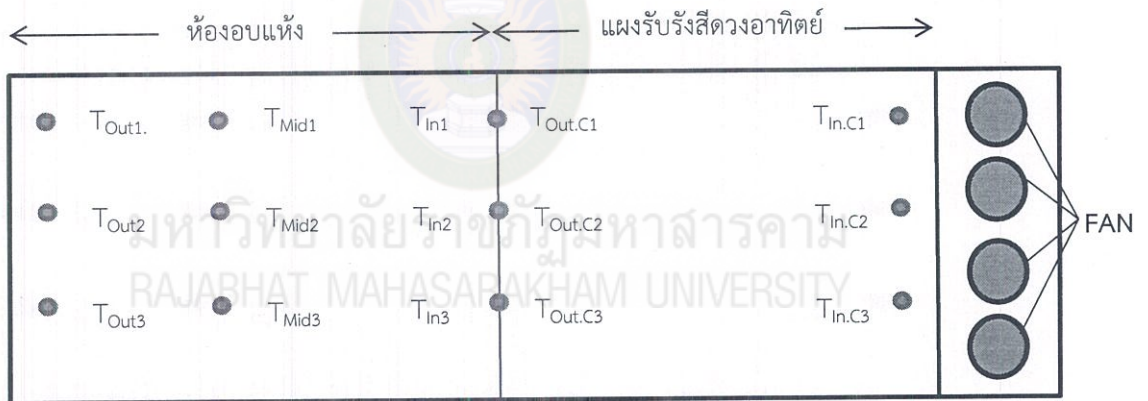
รูปที่ 3.1 ตำแหน่งการวัดอุณหภูมิภายในห้องอบแห้ง
