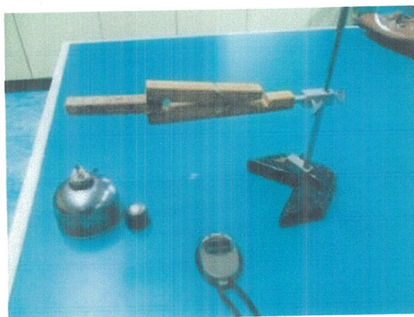
ภาพที่ 3.5 อุปกรณ์ในการศึกษาการอัตราการลามไฟของฉนวนกันความร้อนจากกกขนากและยางพารา
