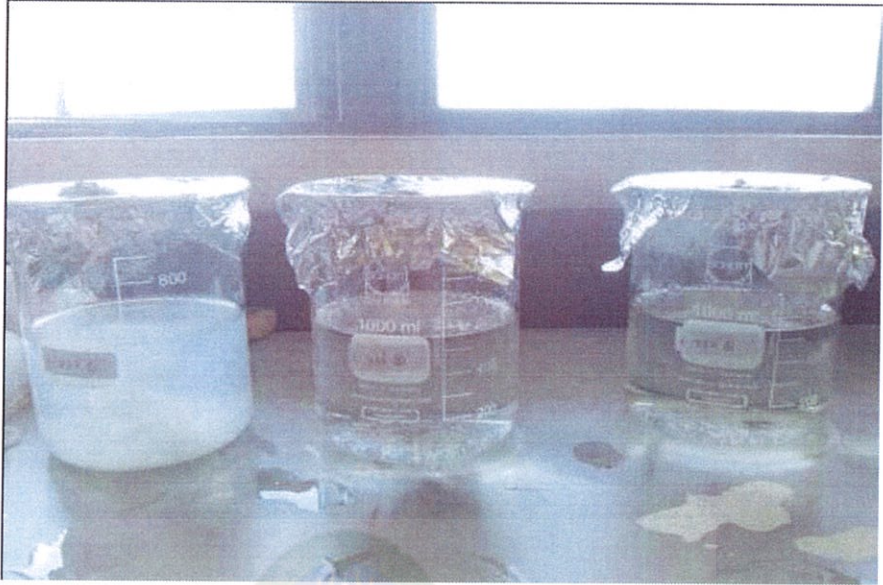
ภาพที่ 6.31 การเทสารละลายใส่ปิกรเกอร์ 1,000 มิลลิลิตร เติมน้ำกลั่น 560 มิลลิลิตร
