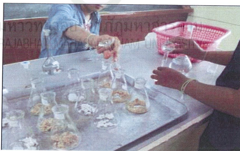
ภาพที่ 6.26 การเติมแอซิดิกแฉ้มนั้น 0.6\% (v/v) 10 มิลลิลิตร และสารละลายโซเดียมไฮดรอกไซด์ แฉ้มนั้น 0.02\% (w/v) 10 มิลลิลิตร สารละลายโซเดียมคลอไรด์ 20\% (w/v) 1 มิลลิลิตร
