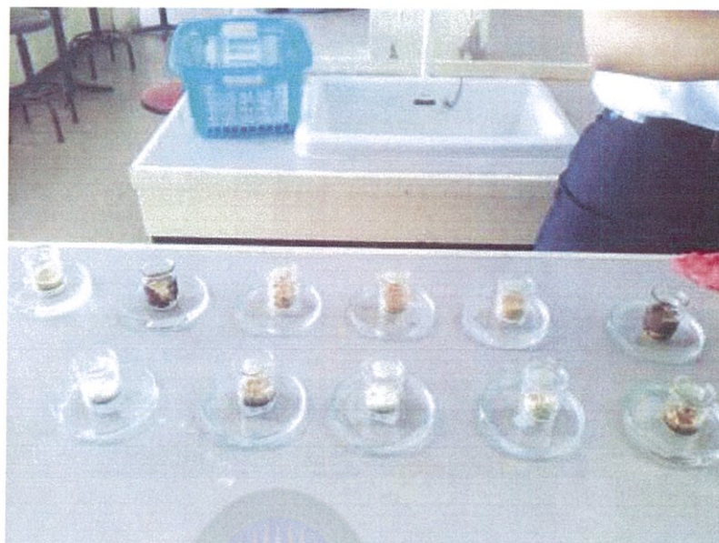
ภาพที่ 6.29 การวาง sinter glass crucible ลงใน dish ที่มีน้ำสูง 1 เซนติเมตร เติมโซเดียมไฮดรอกไซด์เข้มข้น 17.5% (w/v) หรือ 5.21 นอร์มอล 3 มิลลิลิตร คนด้วยแท่งแก้ว นาน 5 นาที
