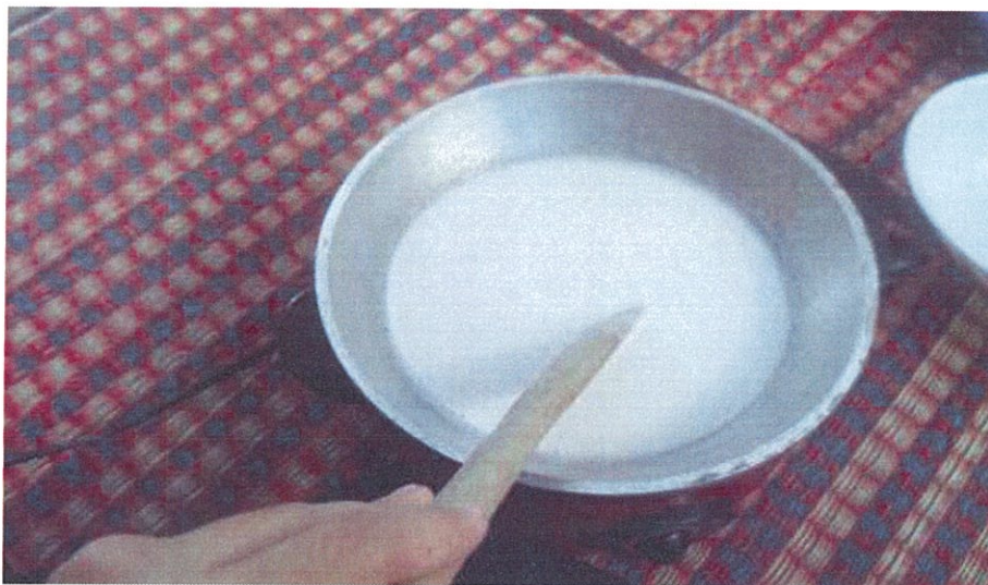
ภาพที่ 6.59 การคนจนเซลลูโลสและผงเต้าฮวยละลายเข้ากัน
