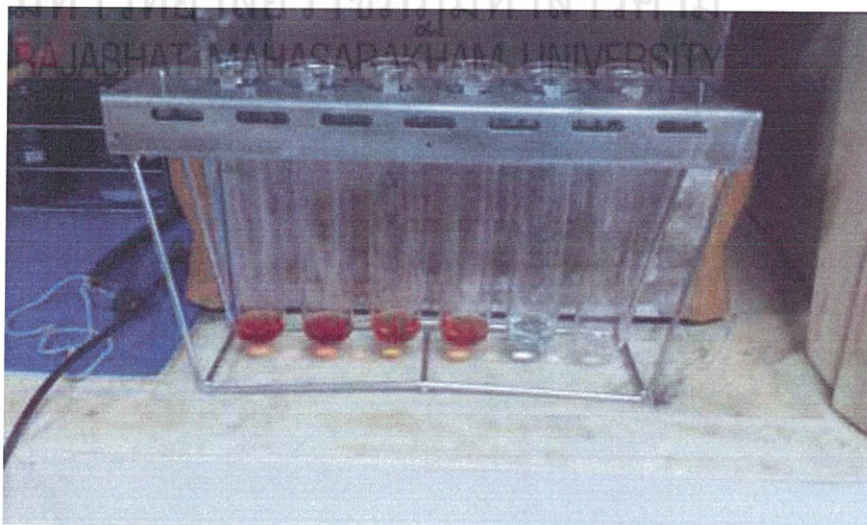
ภาพที่ 6.34 การชั่งตัวอย่างรูปถ่าย 0.5 \pm 0.1 กรัม เติมสารเร่งปฏิกิริยา 5 กรัม + กรดซัลฟิวริก 15 มิลลิลิตร + สารละลายไฮโดรเจนเปอร์ออกไซด์ 36% (v/v) 1 มิลลิลิตรใส่หลอดย่อย
