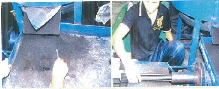
ภาพประกอบที่ 2.25 ขั้นตอนการอัดก้อนถ่านโดยใช้เครื่องอัดก้อน ที่มา : ชาญยุทธ เทพพานิช, 2552
