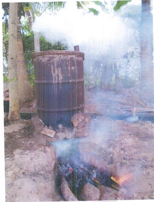
ภาพประกอบที่ ก-1 เตาที่ใช้ในการเผาถ่านมะเลื่อมและผลต้นแดง
