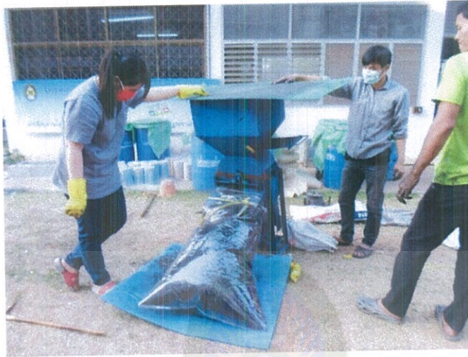
ภาพประกอบที่ 3.7 การบดถ่านเป็นชิ้นเล็กๆ ด้วยเครื่องบด
