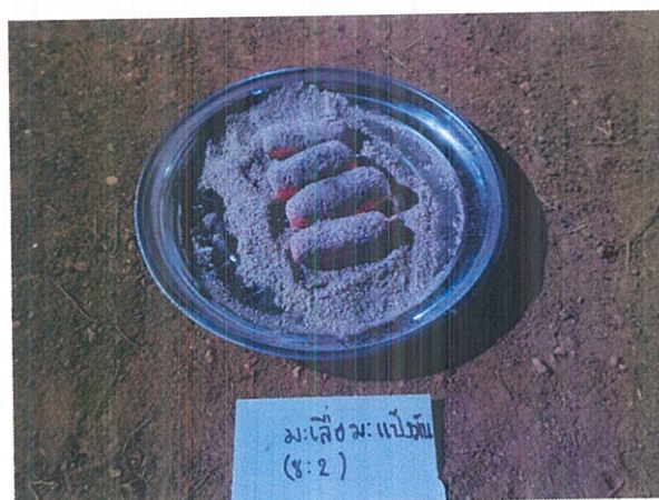
ภาพประกอบที่ ข-16 หาปริมาณเถ้า ระยะเวลาในการเผาไหม้ของ ถ่านอัดแท่งมะเลื่อมในอัตราส่วน 8:2
