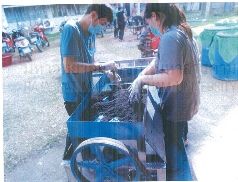
ภาพประกอบที่ ก-6 นำถ่านที่ผสมแล้วมาเข้าเครื่องอัด
