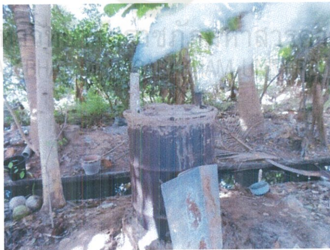
ภาพประกอบที่ 3.4 ปิดปากเตาและรอให้ควันเปลี่ยนสีเป็นสีฟ้า
