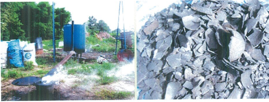
ภาพประกอบที่ 2.20 ขั้นตอนการเผาวัสดุเกษตรก่อนนำไปทำถ่านอัดก้อนในขั้นตอนต่อไป ที่มา : ชาญยุทธ เทพพานิช, 2552
