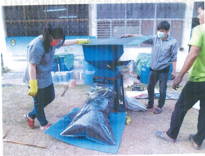
ภาพประกอบที่ ก-2 นำถ่านที่เผาแล้วมาสับเป็นชิ้นเล็กๆด้วยเครื่องบด
