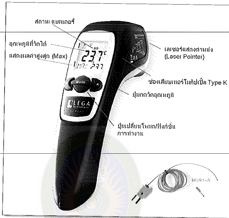
รูปที่ ข-4 เครื่องมือวัด Infrared Thermometer LT760GX
