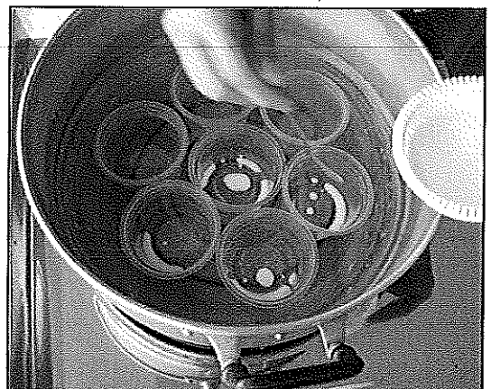
ภาพที่ ก.6 แคลเซียมซัลเฟตผสมน้ำใส่ลงในถ้วย
